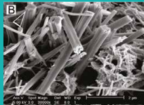
Imagen de alta magnificación de los cristales de fosfato de calcio 1 .
